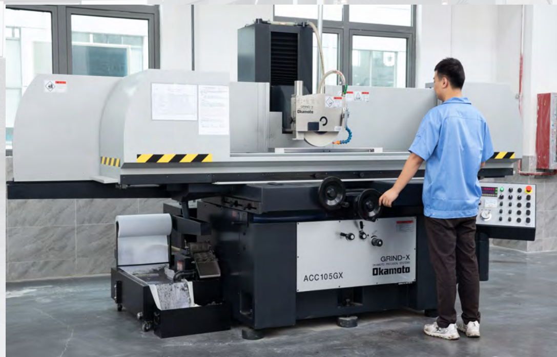
OKAMOTO 冈本平面磨床 ACC105GX 工作台行程: 1150*540
