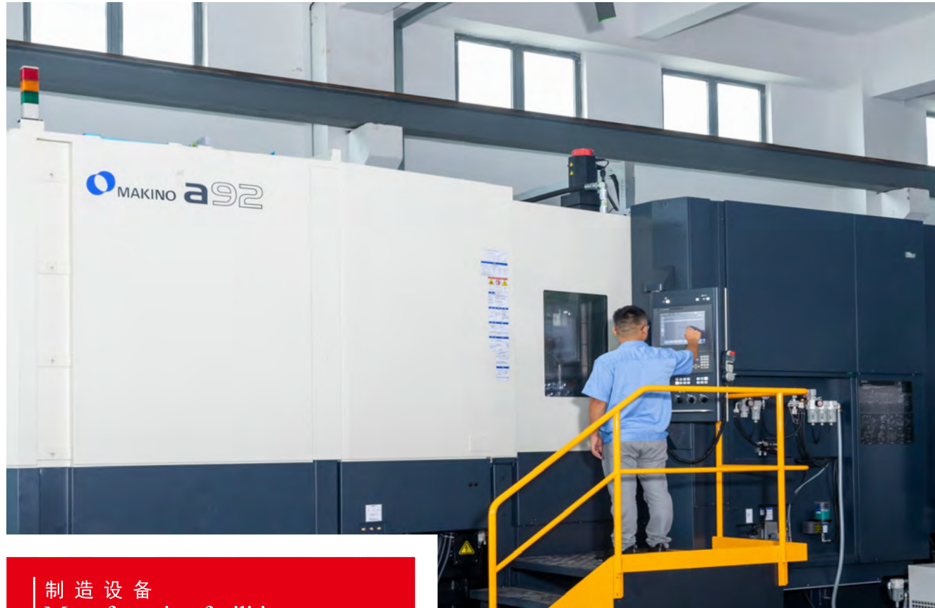
MAKINO 牧野卧式加工中心 a92 轴向行程：1520*1250*1350 X、Y、Z轴光栅反馈0.1μm
