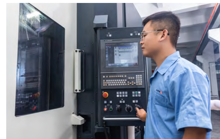
MAKINO 牧野卧式加工中心 a81NX 轴向行程：900*900*1020，X、Y、Z轴光栅反馈0.05μm
