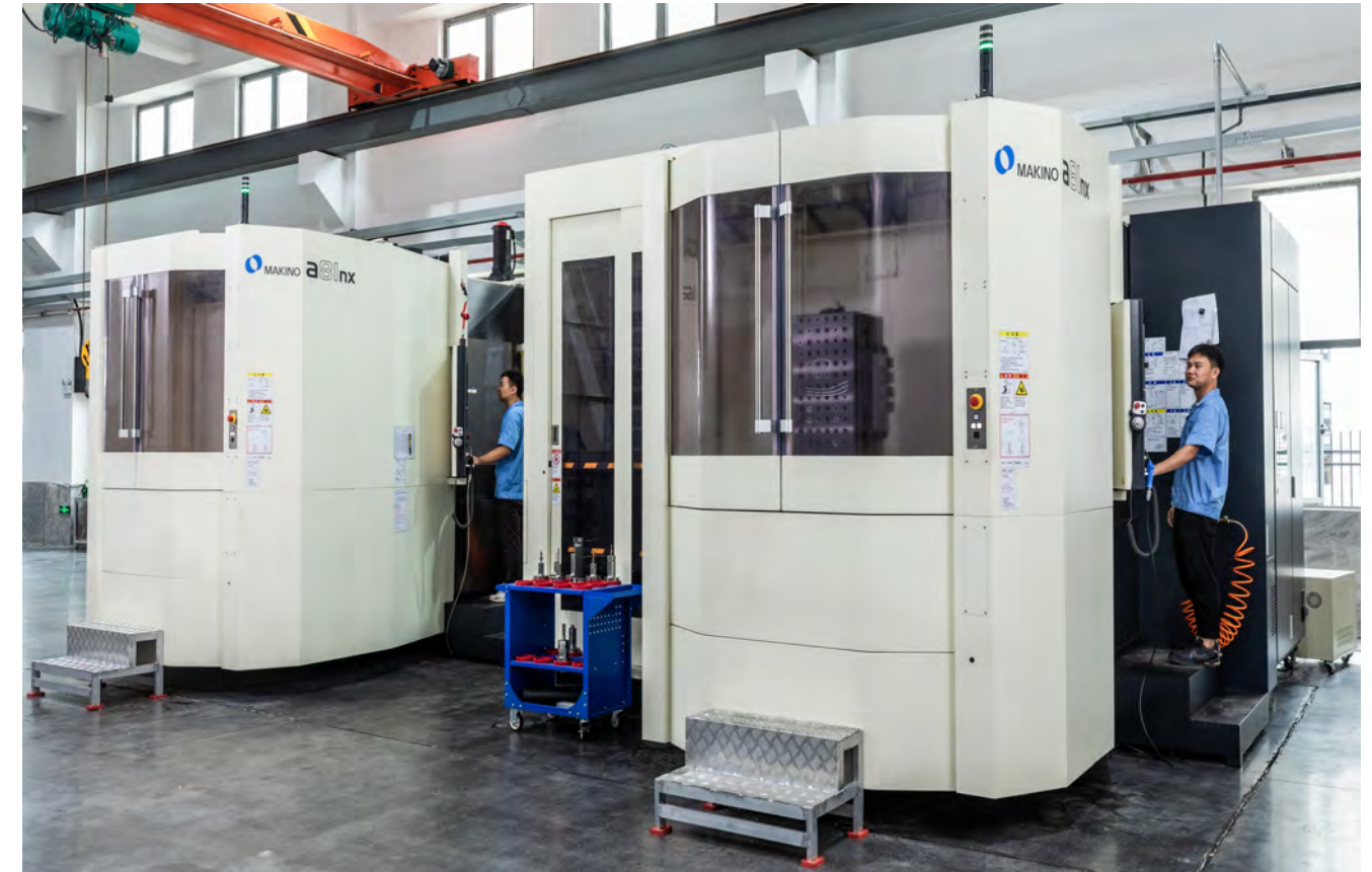
MAKINO 牧野卧式加工中心 a81NX 轴向行程：900*900*1020，X、Y、Z轴光栅反馈0.05μm
