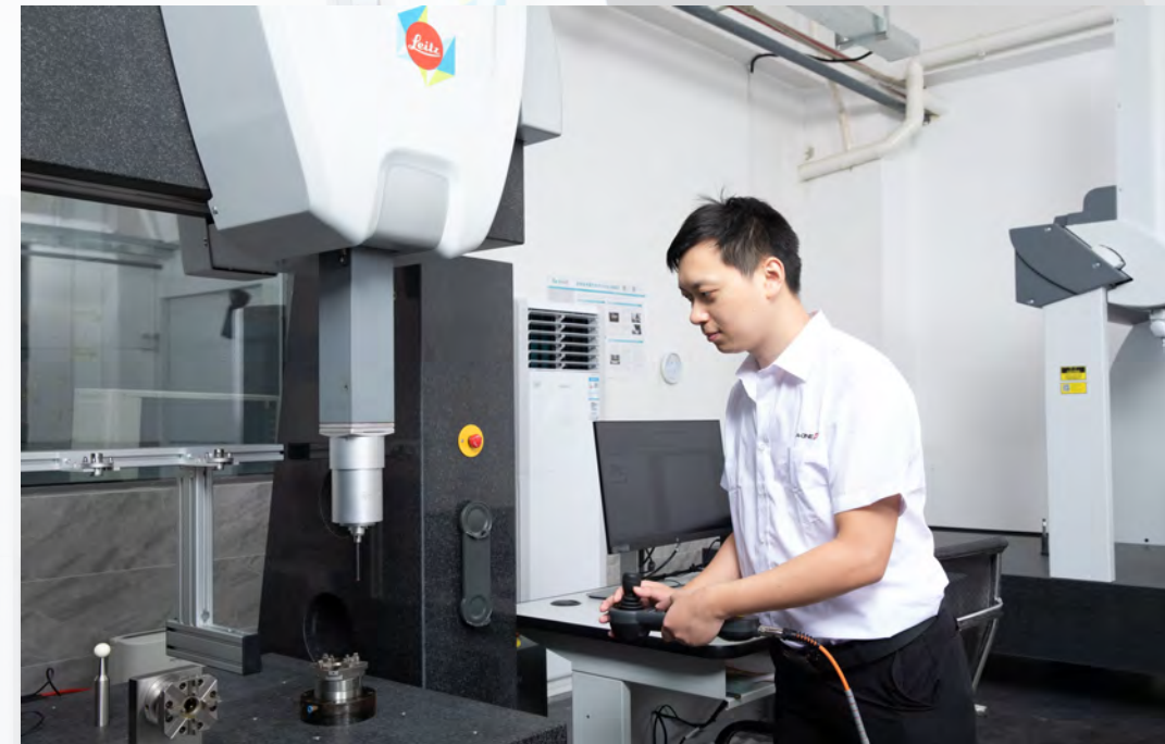
HEXAGON 海克斯康三坐标测量仪 SAGER 06.08.06 行程范围: 600*800*600, 长度测量误差: E_0=0.6+L/400\mu\text{m} , 重复精度: 0.5 \mu\text{m}
